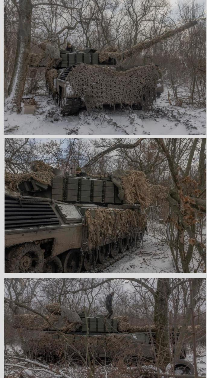
42 no "chassis"). Conta ainda com uma metralhadora co-axial e com outra sobre a torre, ambas em calibre 7,62mm. Está equipado, originalmente, com 8 lança granadas de fumo - distribuídos 4 em cada lateral da torre. Guarnecido por 4 elementos (comandante, condutor, artilheiro e operador de rádio/muniçador), sustenta uma velocidade máxima de 65 km/h e tem um alcance operacional, em estrada, de 600 km.
